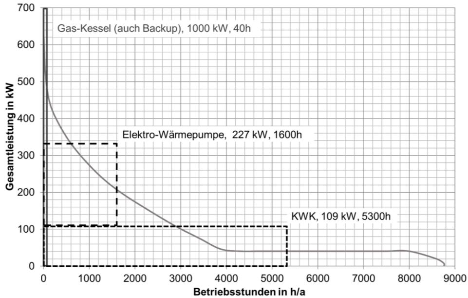
**Abbildung 1:** Beispielhafte Auslegung der Erzeuger nach Jahresdauerlinie
