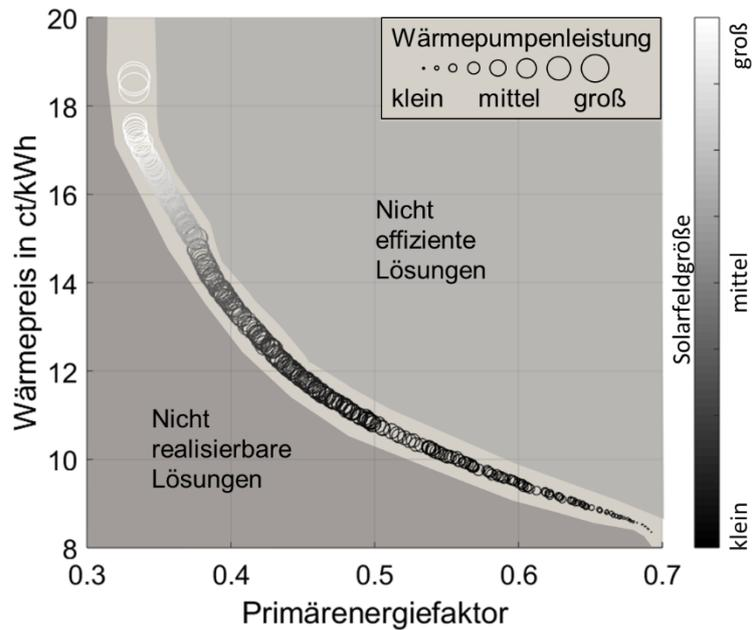
Abbildung 5 Pareto-Front der Systemkonfigurationen zur Versorgung des Nahwärmenetzes
