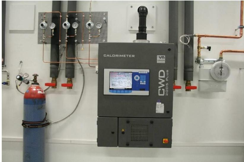
Abbildung 3.15: Gaskalorimeter (Mitte) mit Kalibriereinrichtung (links), Balgengaszähler und weiterer Sensorik (rechts) zur Bestimmung der Gasenergiezufuhr
