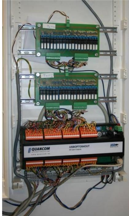
Abbildung 3.13: Emulator für elektrische Temperatursignale: relaisangesteuerte Widerstandskaskade für zwei Temperaturkanäle (Eigenbau)
