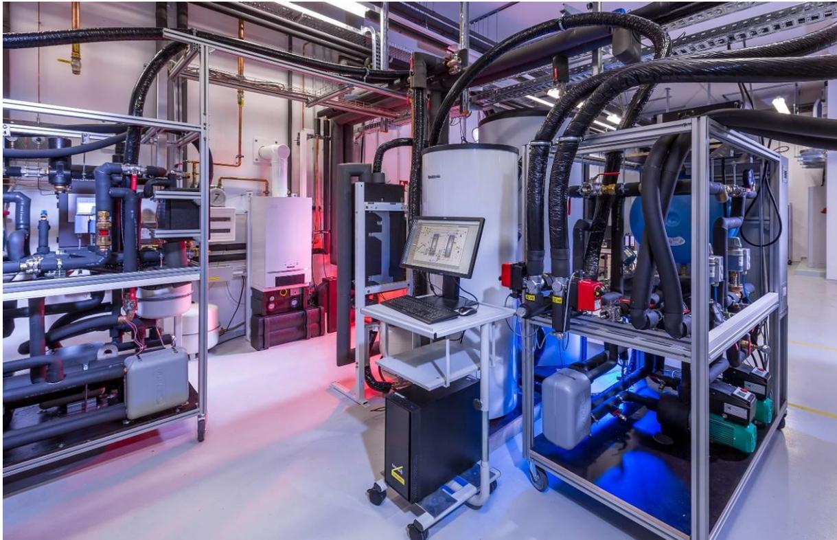
Abbildung 3.12: Teilansicht vom HiL-Prüfstand am ISFH mit eingebauter Wärmezentrale: Solaremulator (links), Gastherme der Wärmezentrale (Mitte, links), Speicher der Wärmezentrale sowie Mess- und Regelrechner (Mitte, rechts), Heizlastemulator (rechts)
