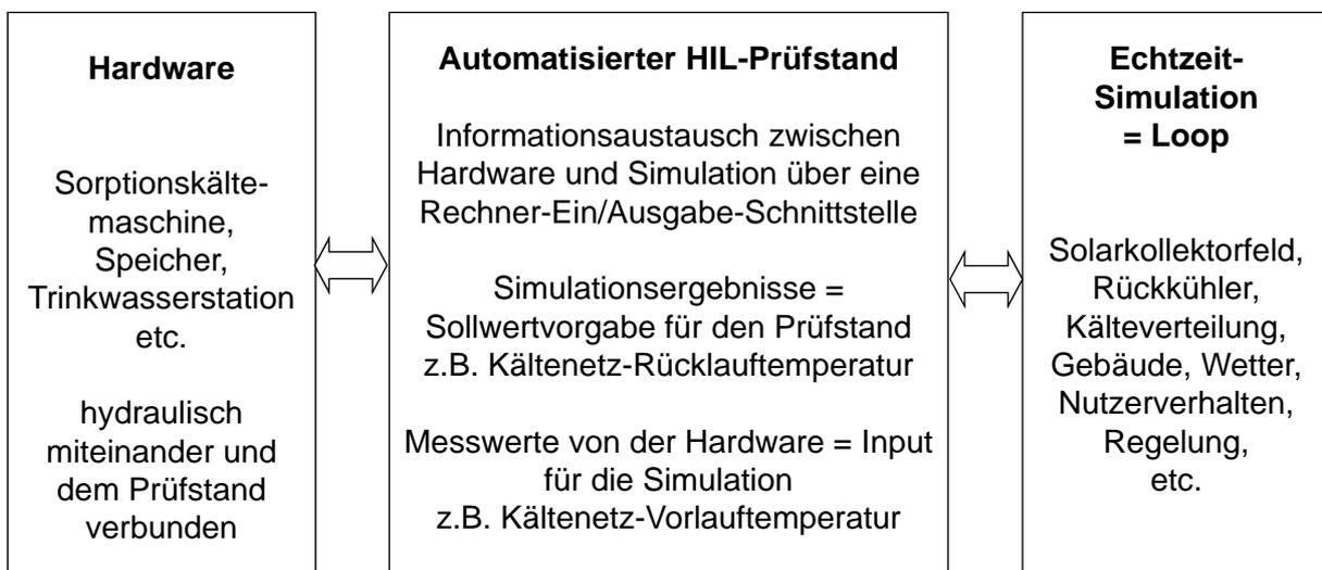
HIL-Prüfstand für Wärmepumpen vorhanden, ausbaubar auf Solare Kühlung
