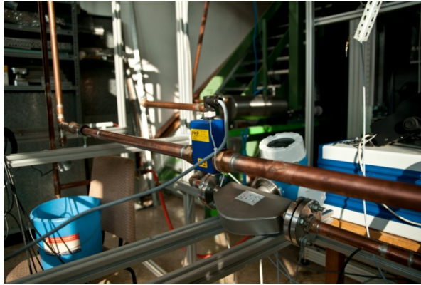
Abb. 80: Referenzmessung Low-Cost-MID mit ungestörter Einlaufstrecke > 10 \times \text{DN}
