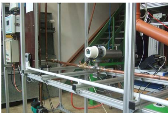
Abb. 74: Vergleichsmessung mit einem Regelventil innerhalb der Einlaufstrecke (Abstand < 3 DN)
