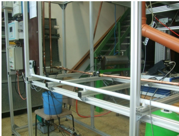
Abb. 95: Referenzmessung DirektSensor VFS 5-100 mit ungestörter Einlaufstrecke > 10 x DN
