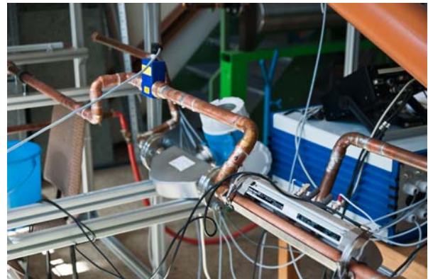
Abb. 101: Vergleichsmessung mit einer 3D-Raumkrümmung innerhalb der Einlaufstrecke
