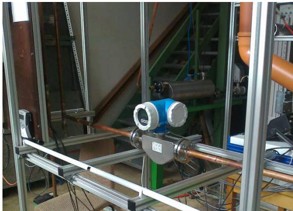
Abb. 104: Referenzmessung Coriolismassendurchflussmessers mit ungestörter Einlaufstrecke > 10 x DN
