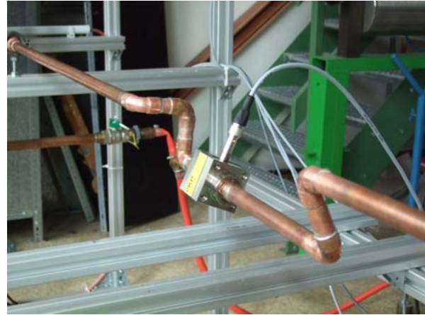
Abb. 86: Vergleichsmessung mit einer 3D-Raumkrümmung innerhalb der Einlaufstrecke (Abstand 3 DN)
