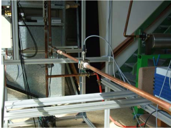
Abb. 85: Referenzmessung Klappendurchflussmessers mit ungestörter Einlaufstrecke > 10 x DN
