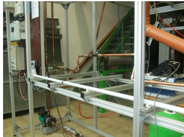
Abb. 96: Vergleichsmessung mit einer 3D-Raumkrümmung innerhalb der Einlaufstrecke (Abstand 3 DN)
