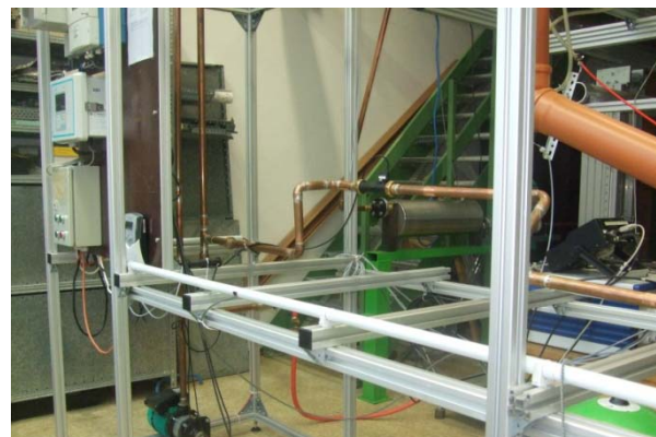
Abb. 92: Vergleichsmessung mit einer 3D-Raumkrümmung innerhalb der Einlaufstrecke (Abstand 3 DN)
