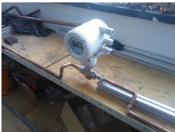
Abb. 76: Vergleichsmessung mit einem 3D-Raumkrümmer innerhalb der Einlaufstrecke
