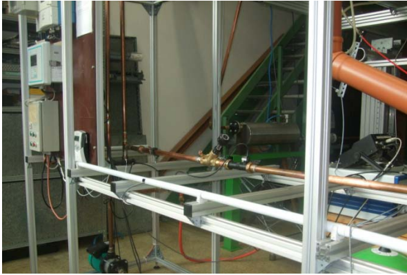
Abb. 93: Vergleichsmessung mit einem Regelventil innerhalb der Einlaufstrecke (Abstand 3 DN)
