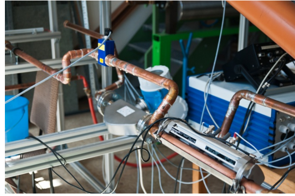
Abb. 81: Vergleichsmessung mit einer 3D-Raumkrümmung innerhalb der Einlaufstrecke (Abstand 3 DN) im Hintergrund
