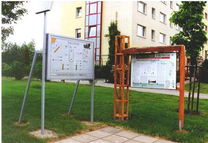
Abb. 007 Ansicht der im Freien aufgestellten Anzeigetafel (energieautark über PV-Modul + Funk-Datenübertragung)(Foto: TU Ilmenau FG TFD 2000)
