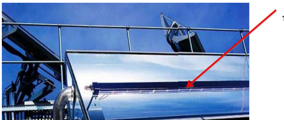
Abbildung 12: PVT-Konzentrator (Quelle: Fa. Absolicon, Schweden)
