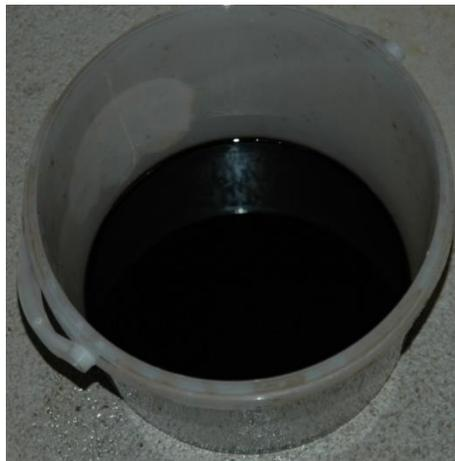
Abbildung 93 Degeneriertes Wärmeträgermedium aus dem Kollektorkreis
