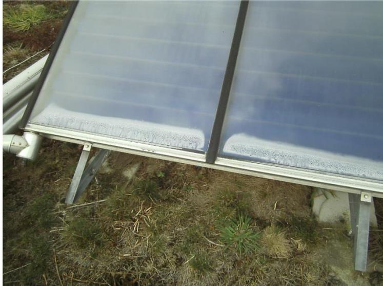
Abbildung 34 Beschlag (kondensierten Wasser) in der Abdeckung mancher Kollektoren
