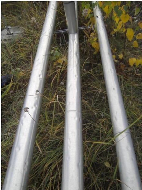
Abbildung 79 Hagelschaden an der Aluminiumverschalung des Kollektorkreises
