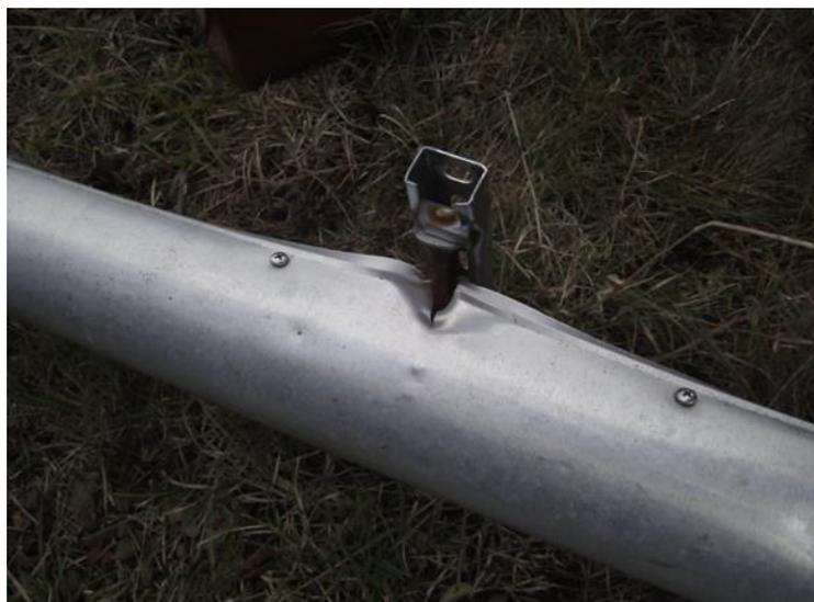
Abbildung 23 aufgerissene Kollektorkreisisolierung durch "weggerostete" Gewindestange
