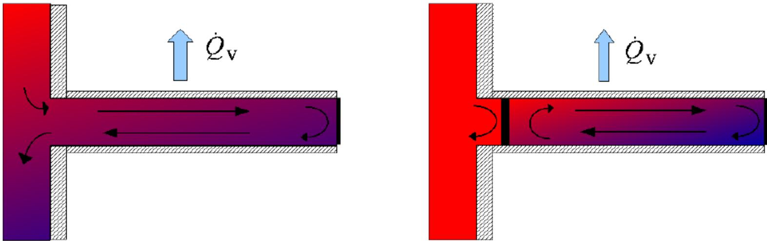
Prinzip der Einrohrzirkulation mit waagrecht angeschlossenen Rohr, links ohne und rechts mit Absperrung zum Speicher
