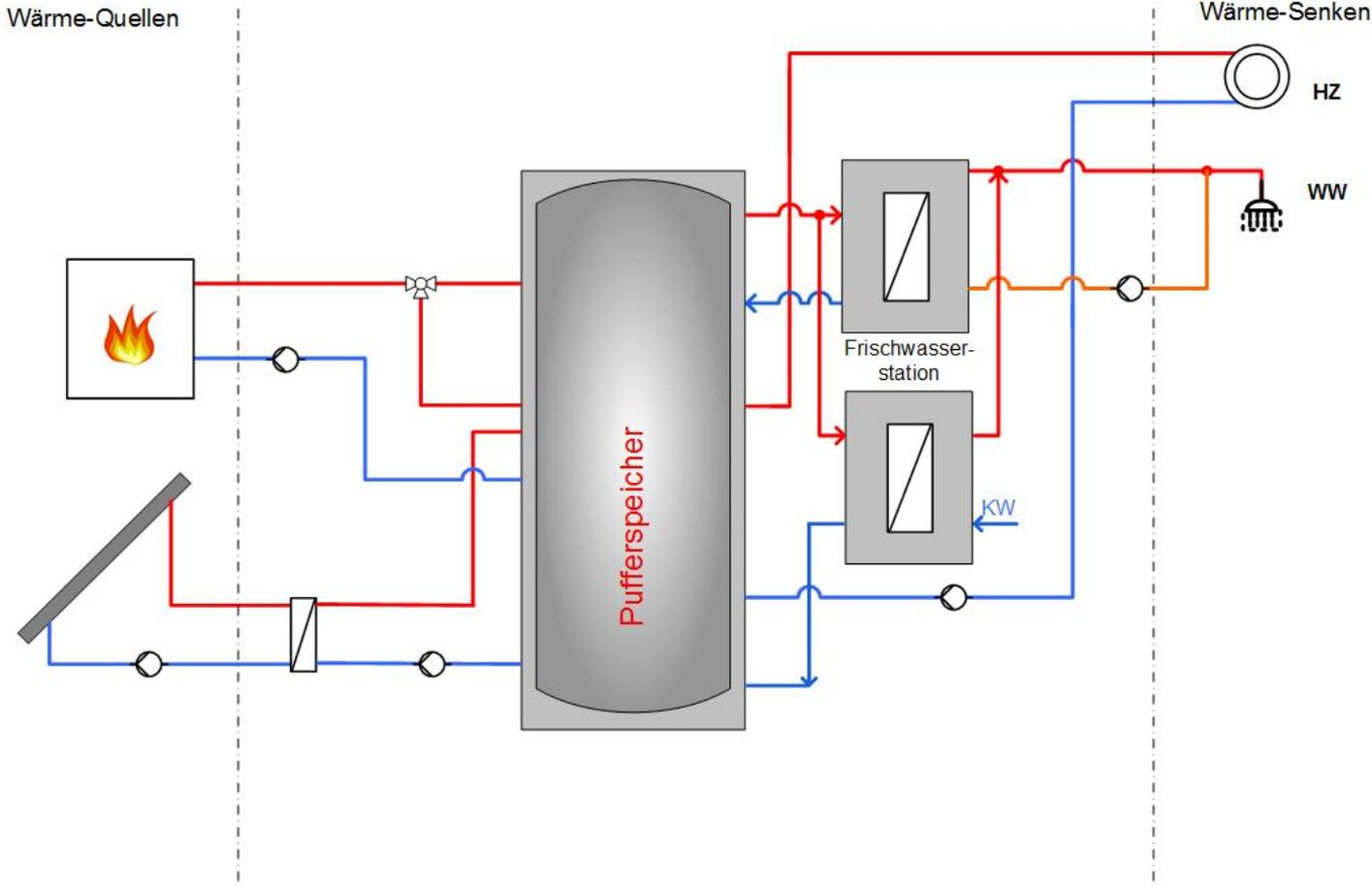
Nicht gezeichnet: Mischventile vor Plattenwärmetauschern, Bypassventil in Solarkreis, Sicherheitsventile, Rückschlagklappen, Regelung, usw. ...
